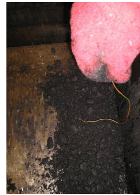
Figuur 5: Aanbrengen thermokoppels
